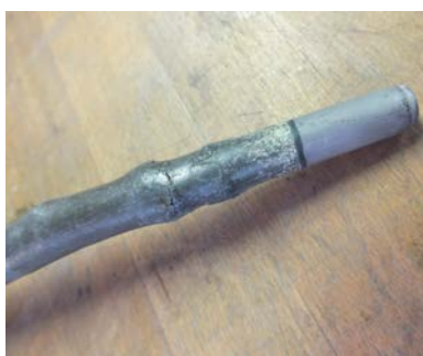
Corrosie van een loden orgelpijp (bron: Flentrop)
